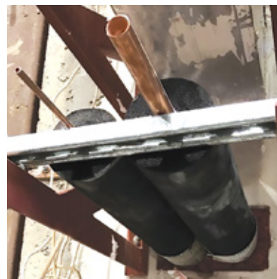
耐火測試前Class 0保溫物料
