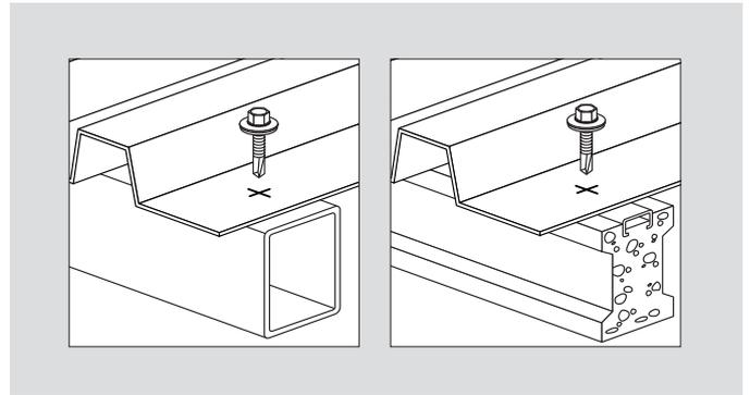
A2不銹鋼版，配合加硬碳鋼鑽頭及橡膠墊片配套
