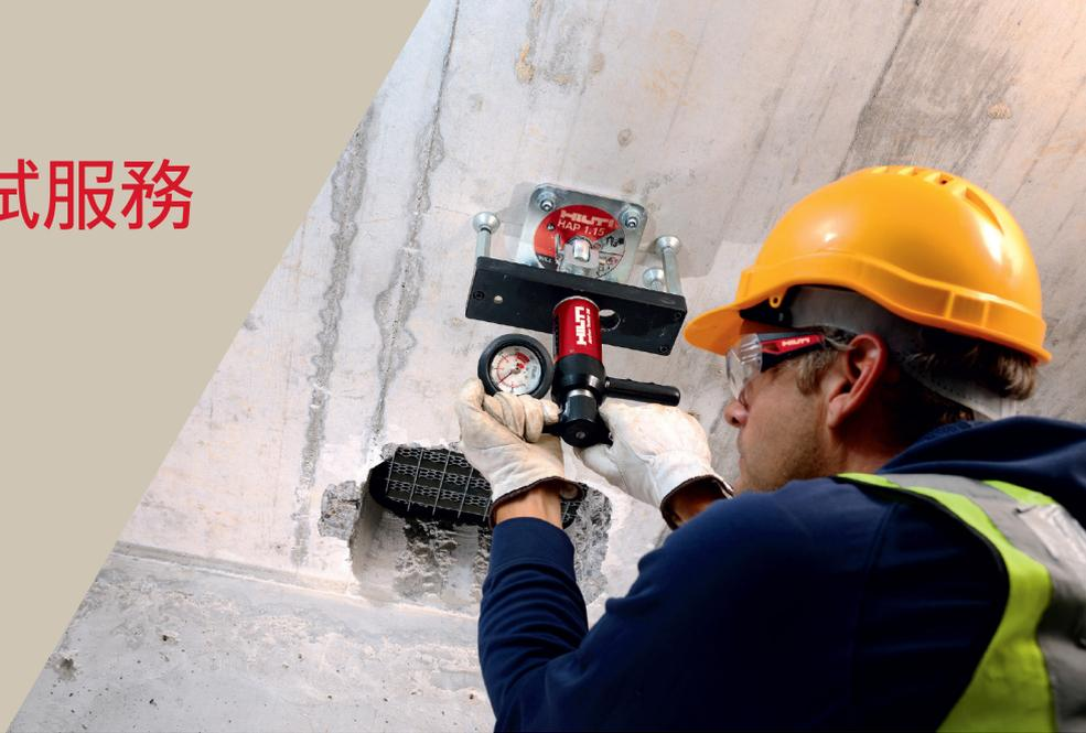
為確保安卡錨栓的正確安裝，選取可靠物料與工程的質量監控同樣重要。除對工人的安裝培訓外，安卡錨栓拉力測試也是質量監控的常用方法。以下獨立實驗室便能為您提供一站式服務：
