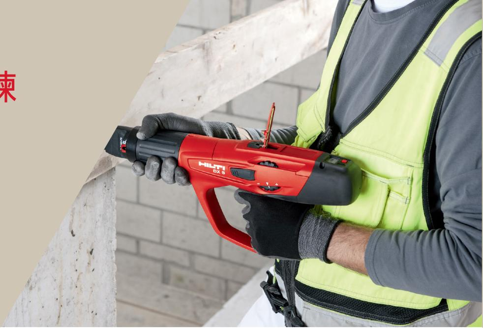
槍彈推動擊釘工具常用於建築及維修工程，如緊固間隔牆鐵槽、安裝天花角碼、吊燈盤及釘木板等工序，是一款可提高生產力的多功能工具。槍彈推動擊釘工具使用訓練課程是由本公司聯同勞工處制訂，以加強業內人士對該等工具之操作及安全使用兩大環節上作出專業的指導。
