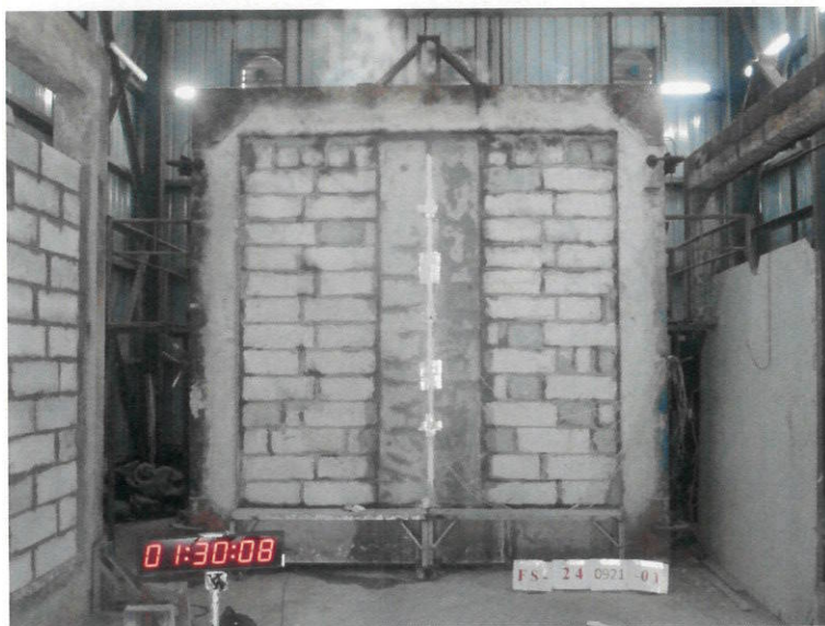
圖 15 測試 75min 後試件背火面
