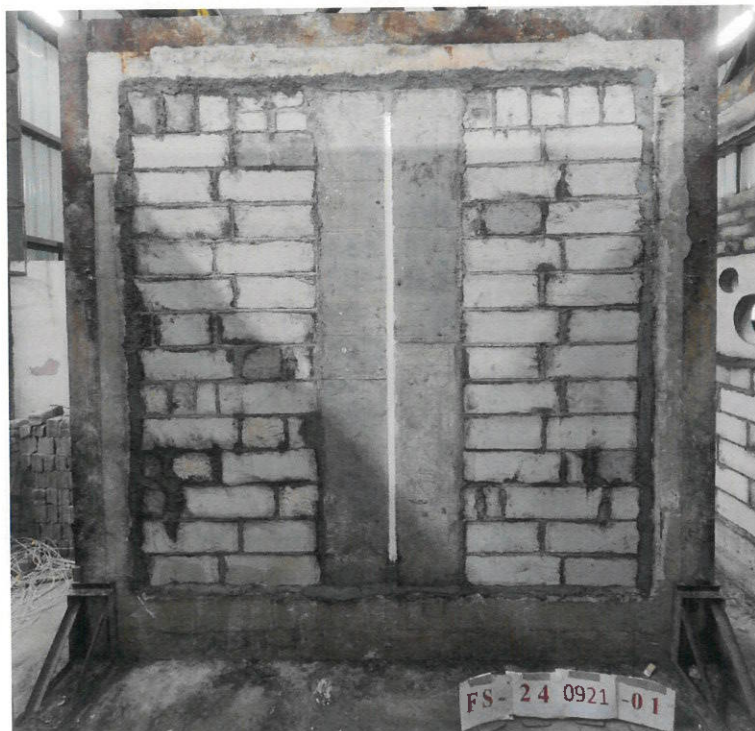
圖 9 測試前試件向火面
