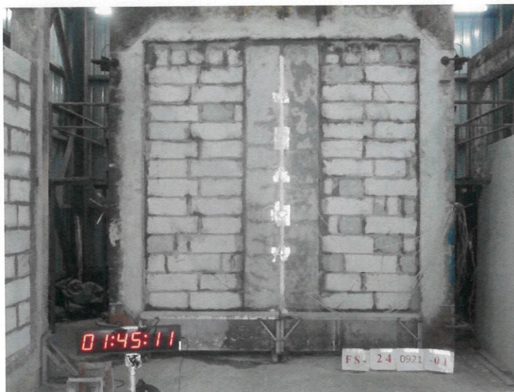
圖 17 測試 105min 後試件背火面
