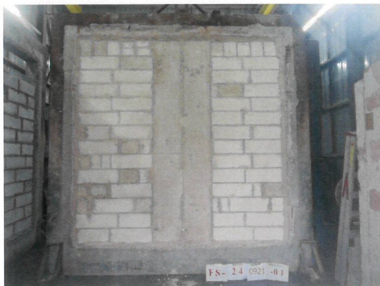
圖 27 測試後試件向火面
