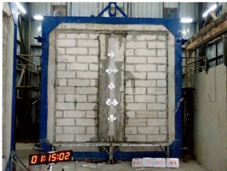
圖 15 測試 75min 後試件背火面
