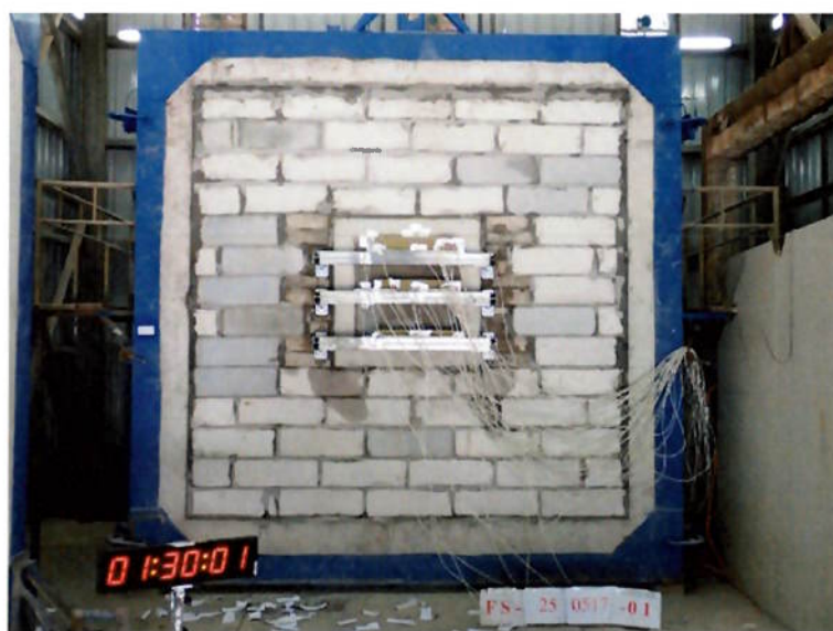
圖 15 測試 90min 後試件背火面
